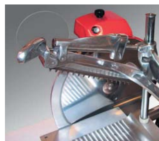
Brazo articulado para una perfecta sujeción del producto.
