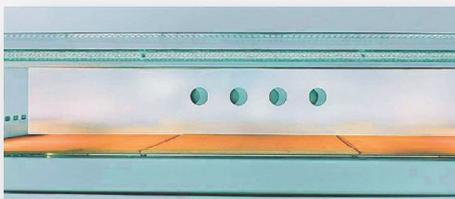
La evacuación de vapores se realiza mediante orificios situados en la pared del fondo de la cámara cuya apertura se controla eléctricamente.
