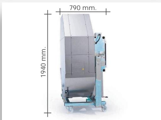
El horno se suministra sobre un soporte con ruedas y girado 90° de manera que facilita las fases de transporte e instalación permitiendo incluso el paso a través de puertas a partir de 80 cm.
