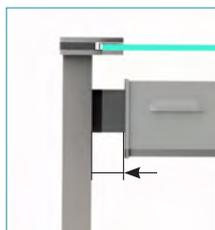
Todos los elementos en contacto o próximos a los alimentos deben ser fácilmente accesibles para su higiene. Hemos separado ligeramente el soporte de la pantalla, para que las operaciones de limpieza sean cómodas y eficientes.
