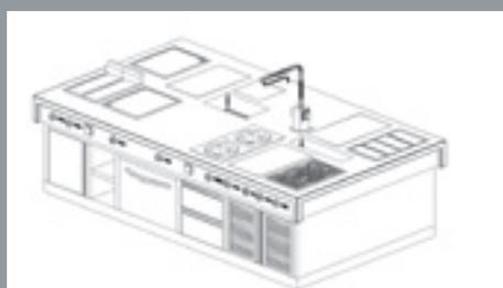
En cualquiera de las versiones, mural o central, la encimera descansa sobre un mueble inferior capaz de alojar diferentes tipos de elementos de almacenamiento y apoyo: abiertos o cerrados; neutros, fríos o calientes; hornos eléctricos; armarios técnicos para conexionado y acometidas...
