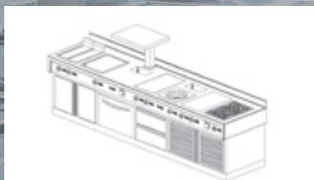
Cocina con apoyo a pared, donde la maquinaria y elementos funcionales se ubican linealmente. Provista de peto posterior a modo de embellecedor y como protección trasera.
