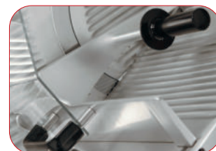
Protecciones de seguridad.
